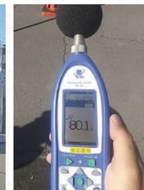
防音ゲートの効果を確認するため騒音計で規制値の85dBを下回っていることを確認します。
