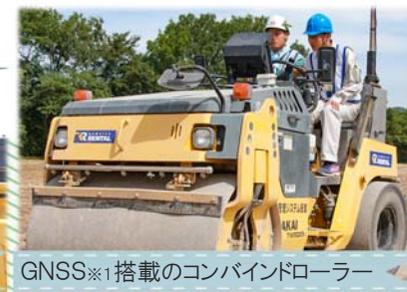
GNSS※1搭載のコンバインドローラー
