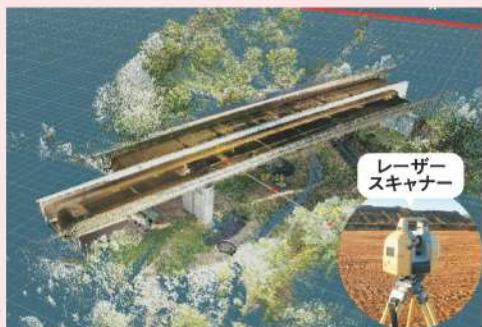
レーザースキャナー(測量機器)を使い、周囲の情報を3次元データ(3D)で取得できます。
